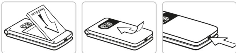
1. Insérez la batterie de sorte que les contacts de la batterie touchent les contacts dorés du téléphone portable.
