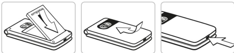
1. Inserire la batteria in modo che i contatti della batteria tocchino i contatti dorati del cellulare.
