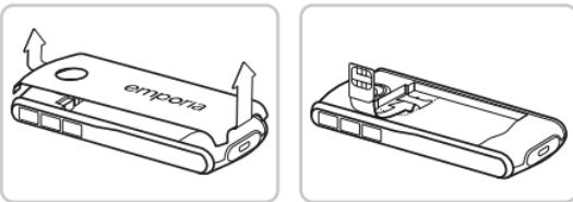
1. Entfernen Sie den Akku-Deckel (Ausnehmung links oben).
